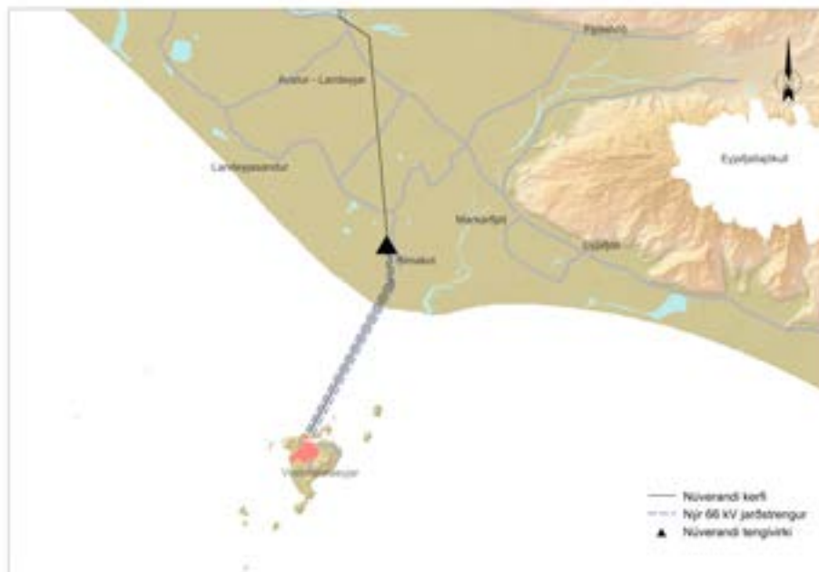
Mynd 7-7: Bláu línurnar sýna áformaða styrkingu raforkuflutnings á milli Vestmannaeyja og Rimakots.
