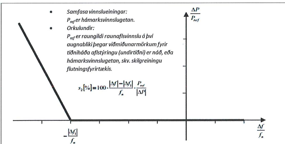
**Mynd 2** Tíðniháð afstýring vinnslueininga við undirtíðni (mynd frá European Commission: „Network code on requirements for grid connection of generators“).
